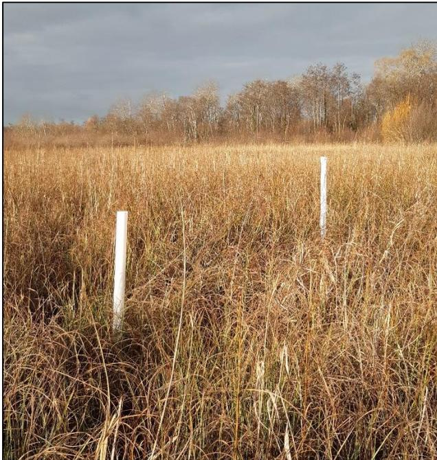
Tubes implantées dans une cladiaie avec un sonde piézométrique de surface et un sonde piézométrique de profondeur (base de la tourbe, -5m)
